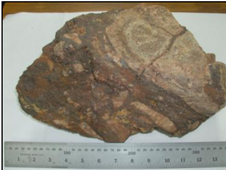
IV.H. Brecha mineralizada, en donde se observan la alineación de los clastos de hornfels cementados en mineral de hierro.
