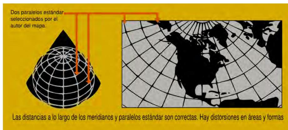
Figura 2.13: Proyección Equidistante, *Cónica Simple Modificado* y traducido del original con permiso del *U.S. Geological Survey*.
