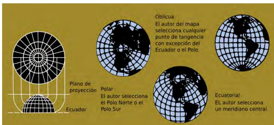
Figura 2.10: Proyección Azimutal Equidistante. Modificado y traducido del original con permiso del *U.S. Geological Survey*.
