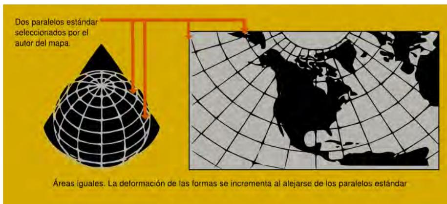
Figura 2.11: Proyección de Área Equivalente de Albers. Modificado y traducido del original con permiso del U.S. Geological Survey.
