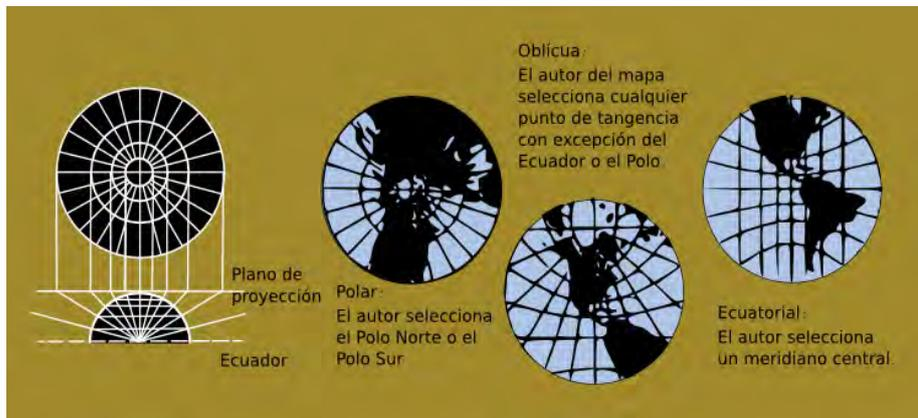
Figura 2.9: Proyección Gnomónica es tres aspectos diferentes; polar, oblicua y ecuatorial. Modificado y traducido del original con permiso del U.S. Geological Survey.
