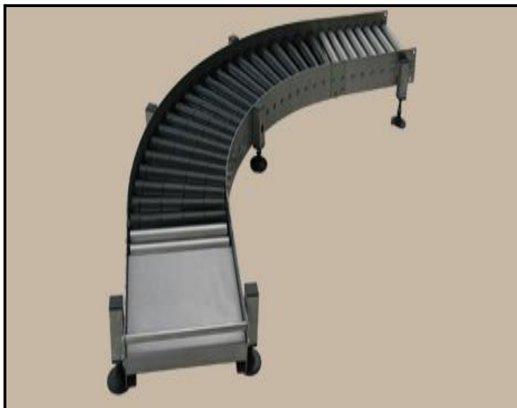
Figura 3.32 Banda transportadora que tiene movimiento por gravedad conocida como roller conveyer (FAS, 2010).
