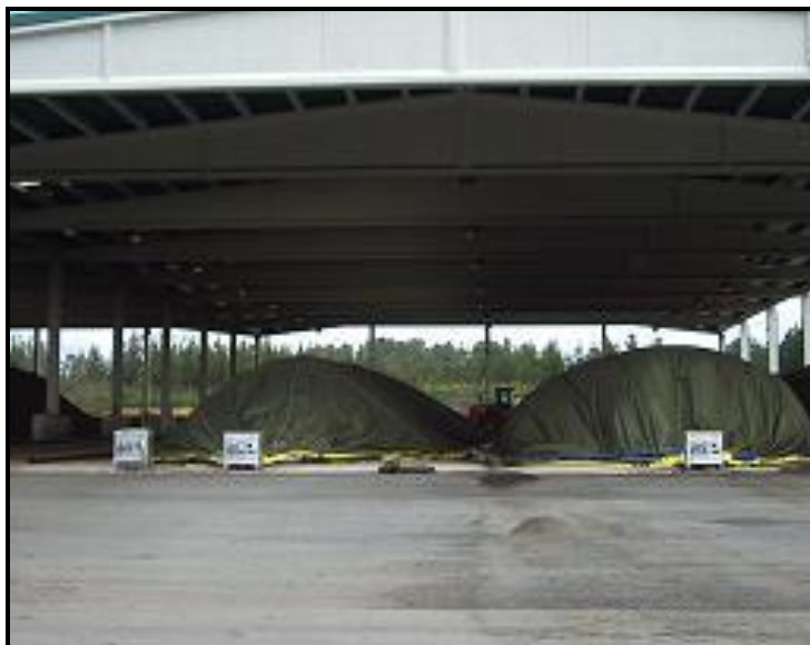
Figura 3.2 Pilas estáticas aireadas de la empresa TRADEBE. Fuente: http://www.tradebe.com
