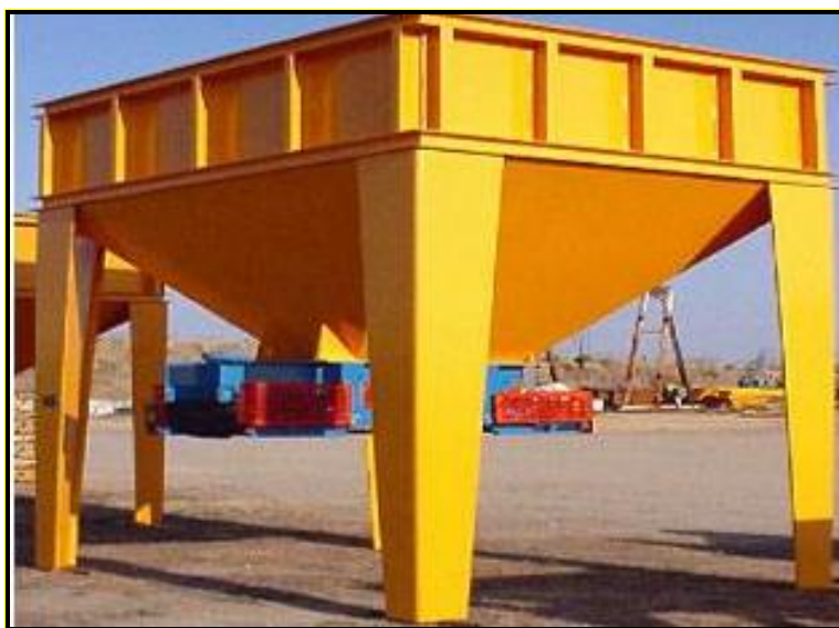
Figura 3.22 Tolva de recepción de residuos (flujo masa). Fuente: http://www.maquias.com
