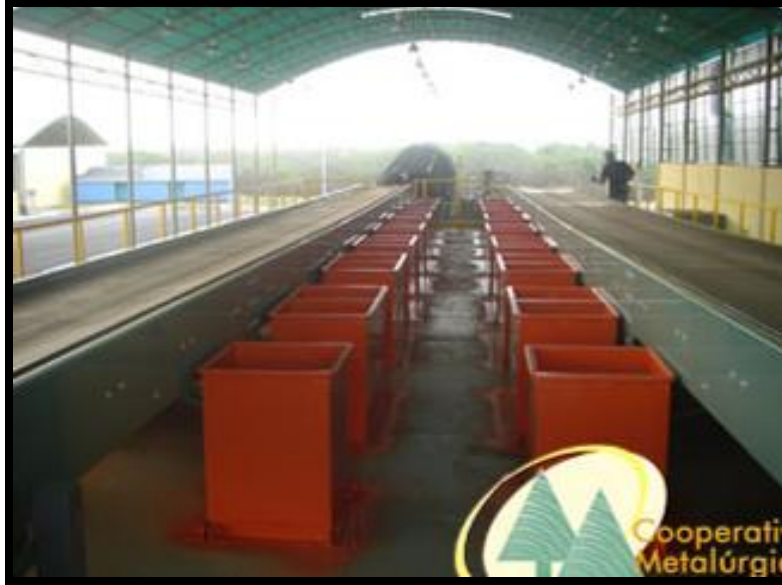
Figura 4.8. Bandas transportadoras con selección manual.
