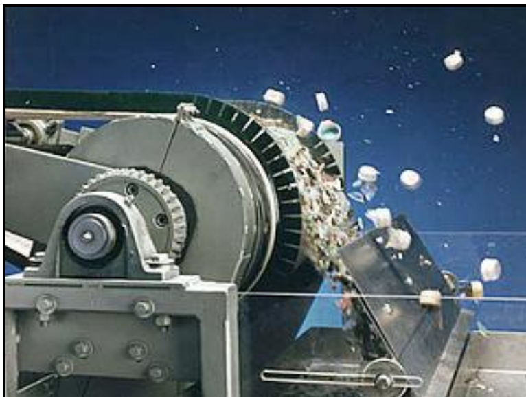
Figura 3.38 Separador para corriente de Foucault (metales no ferrosos), marca ERNIEZ.
