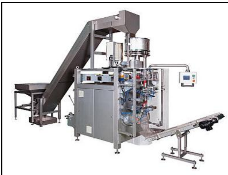
Figura 3.9 Ensacadora HBV 3U, con alimentación, ensacado y sellado mecánico, además de banda transportadora para la alimentación del producto y el transporte de los sacos.
