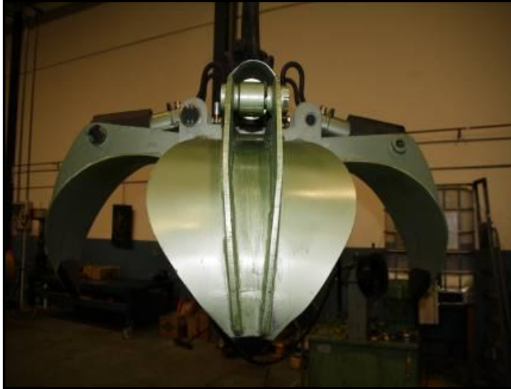
Figura 3.24 Aditamento que lleva la grúa, se conoce como pulpo o almeja. Fuente: http://www.fernie.es/
