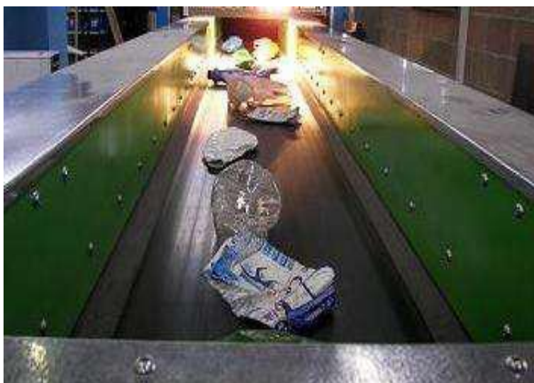
Figura 3.21 Separador óptico de plásticos marca ECOGLASS. Fuente: http://www.picvisa.com/
