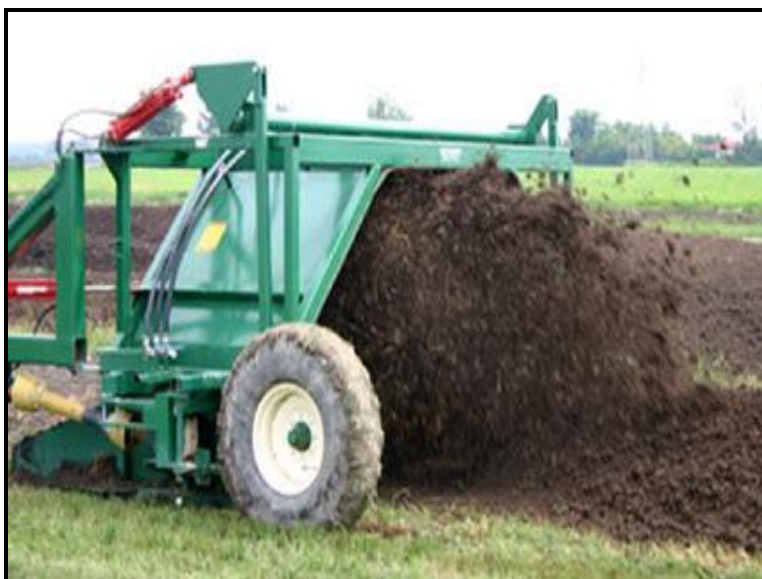
Figura 3.7 Mezcladora de composta (Bioactive Windrow Compost Turner – 1800). Fuente: http://www.groundgrocer.com/product.asp?pi=196
