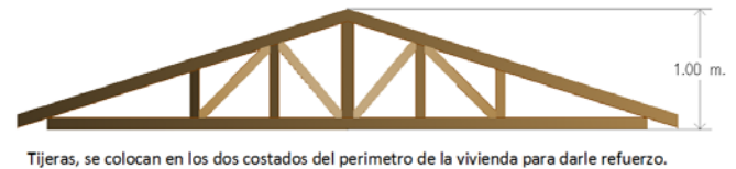
Tijeras, se colocan en los dos costados del perímetro de la vivienda para darle refuerzo.
