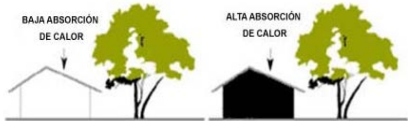
Figura 21. Los colores claros en paredes permiten rechazar parte del calor incidente. Manual de diseño para edificaciones energéticamente eficientes en el trópico. IDEC. Venezuela.
