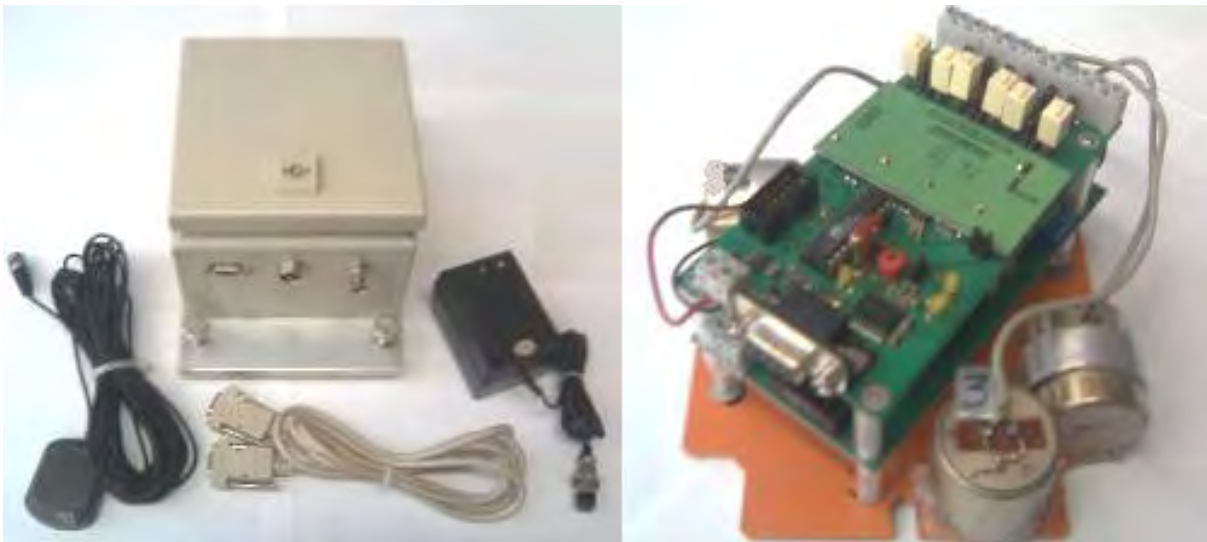
Figura 2.25. Unidad sísmica SR04.
