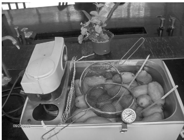
Figura 11. Equipo para el tratamiento hidrotérmico.
