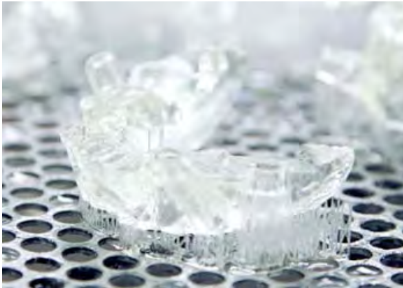
Fig. 44 Elaboración de la guía quirúrgica con estereolitografía por láser
