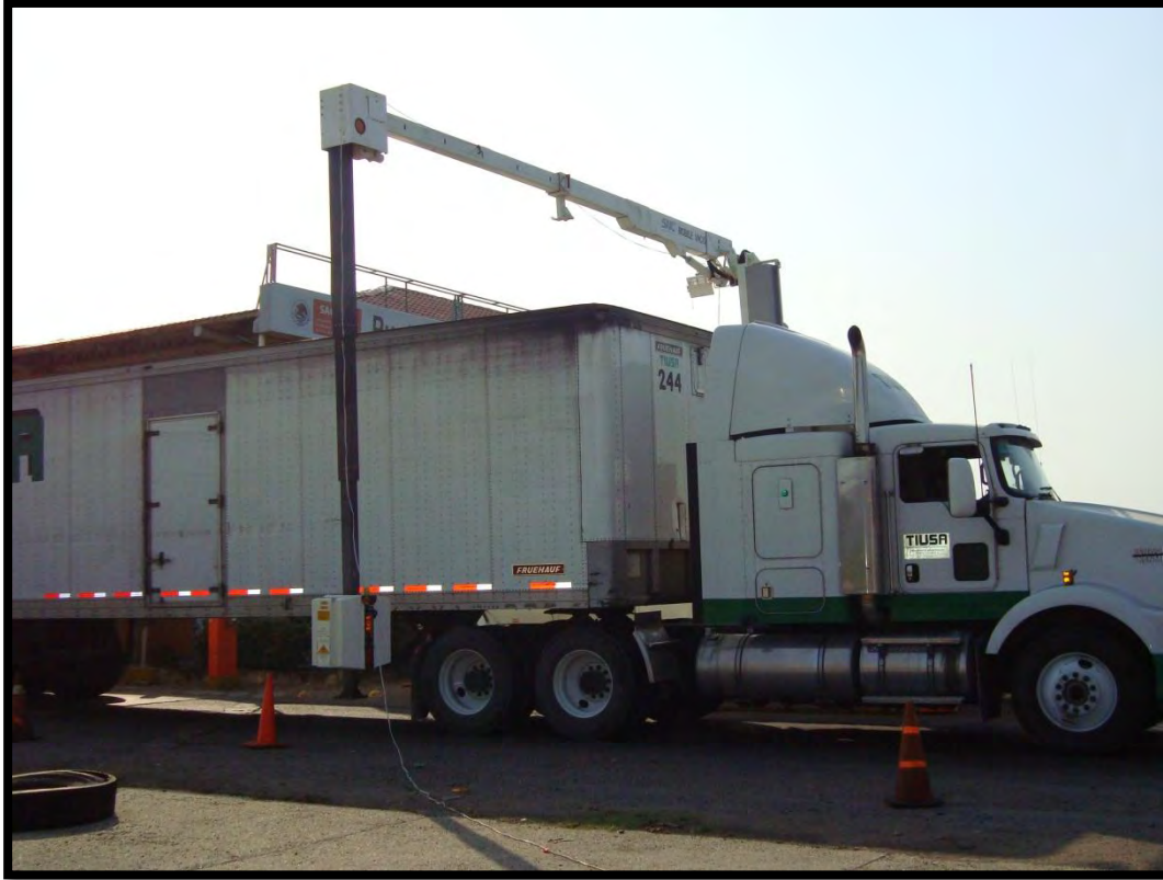
Ilustración 4. Inspección realizada con Sistema VACIS Móvil, duración una inspección 5 minutos.
