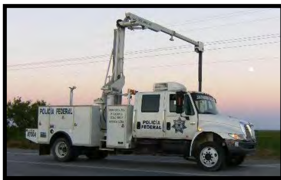
Ilustración 1. Sistema VACIS Móvil. Unidad Especializada en Detección de Drogas, Armas y Mercancías Ilícitas de la Policía Federal.
