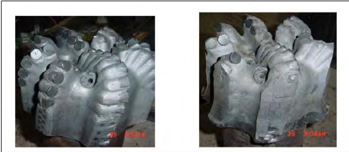
**Figura 3.6 Daños en la Barrena por Vibración. (Graham Mensa-Wilmot, 2010)**
