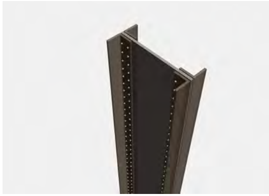
Figura 41. (izquierda) Columna formada por placa y cuatro ángulos simétricos con remaches. Utilizado en el Archivo de concentración del IMSS. Calle Sabino esq. Clavel.
