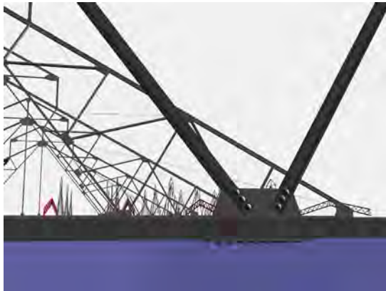
Figura 34 (izquierda) Nudo del cordón inferior con barras, por medio de placa y remaches.
