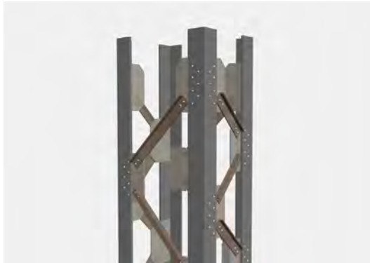
Figura 43. (izquierda) Columnas con cuatro ángulos simétricos y pies derechos unidas con placas y remaches. Utilizado en el Edificio Esmeralda, contemporáneo de la época de estudio, ubicado en Isabel la Católica y Madero, Centro Histórico.
