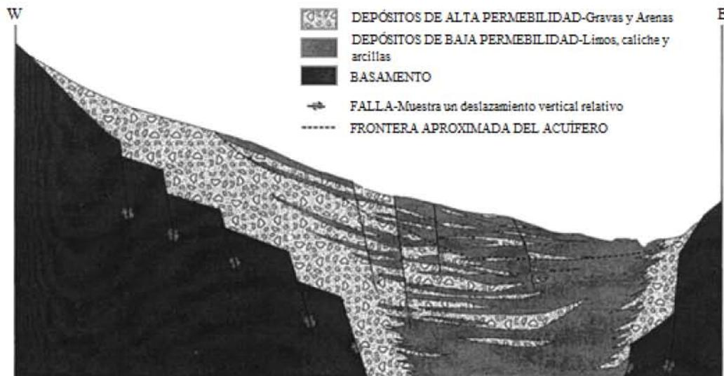
Figura 3.12. Localización y sección E-W de fallas en el Valle de Las Vegas, Nevada EU. (Burbey T. J. 2002)
