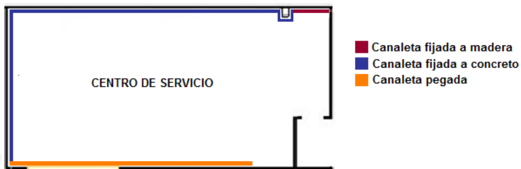
Figura 53. Instalación de canaleta en el centro de servicio.
