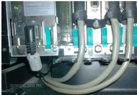
Figura 100. Distribución de los cables del conector amphenol
