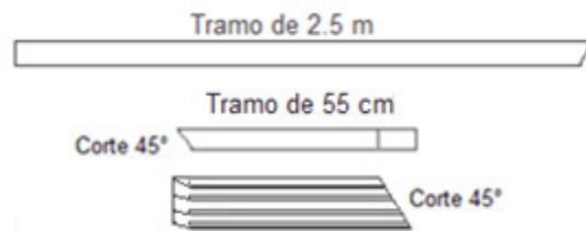
Figura 65. Medidas y ángulos de los tramos a ensamblar pegados en el almacén.
