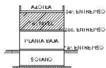
CORTE ESQUEMATICO DEL EDIFICIO
