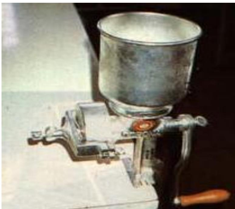
Fig.23. Molino manual para la molienda de peces.
