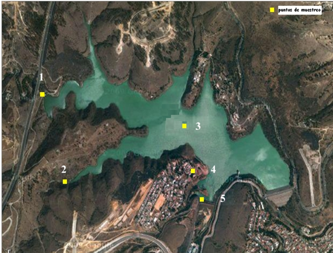
Fig. 6 Localización de los puntos de muestreo para valoración de la calidad de agua en la Presa Madín 1. Río Tlalnepantla, 2. Río San Juan, 3. Cabeza de Tortuga, 4. Pozo de Presa Madín, 5. Represa
