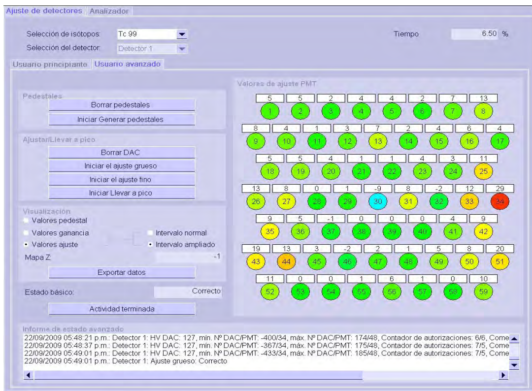
Figura 4.2. La imagen muestra un ejemplo de la sintonización. Se visualiza de manera esquemática a los 59 TFM acoplados al cristal centellador.
