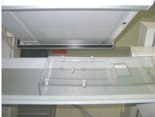
Figura 3.10. Maniquí utilizado para las pruebas del desplazamiento del COR sobre la camilla de la CG.
