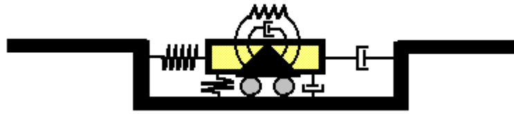
Figura III.1. Resortes y amortiguadores equivalentes del suelo
