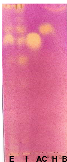
Figura 45. Análisis cromatográfico cualitativo en capa fina de los componentes mayoritarios en la infusión de hojas de Prunus serotina (E=extracto, I=Infusión, AC=ácido clorogénico, H=hiperósido y B=benzaldehído).
