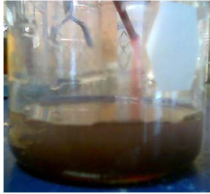
Fig. 4.5. Retiro de azúcar libre, sabor y otros componentes orgánicos, con la solución de acetato de amonio.
