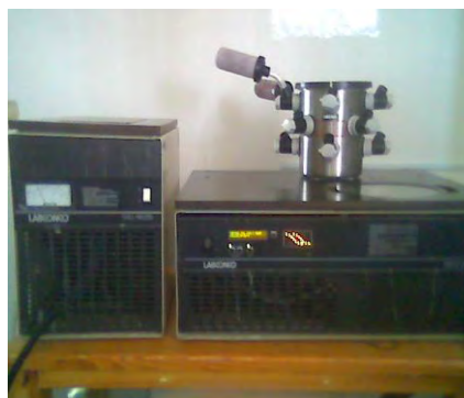
Fig. 4.9. Montado de muestras en el equipo de liofilización.
