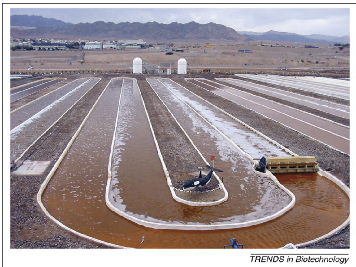
Figura 3.12. Estanque tipo circuito de carreras en Nature Technologies Ltd (Eliat, Israel), una subsidiaria de Nikken Sohonsa Co. (Gifu, Japón, http://www.chlostanin.co.jp )
