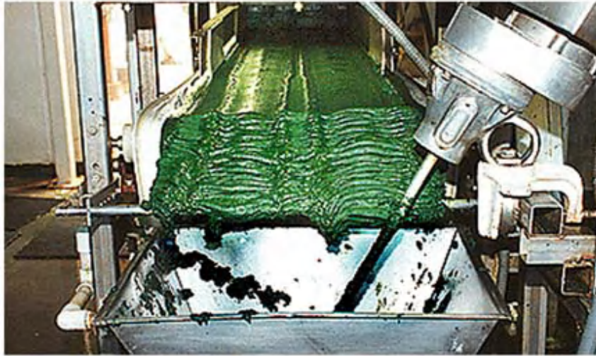
Figura 5.7. Biomasa de microalgas recuperado por filtración del caldo de cultivo, que se mueve a lo largo de una cinta transportadora en Cyanotech Corporation, Hawaii, EE.UU( www.cyanotech.com ). Fotografía de Lucas Terry. Cortesía de Honolulu Star-Bulletin (Schenk et al., 2008)
