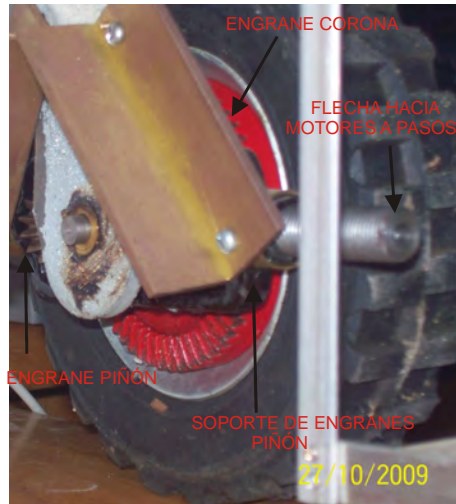
Figura 3.4: Acoplamiento de la relación de engranes con la rueda del robot móvil
