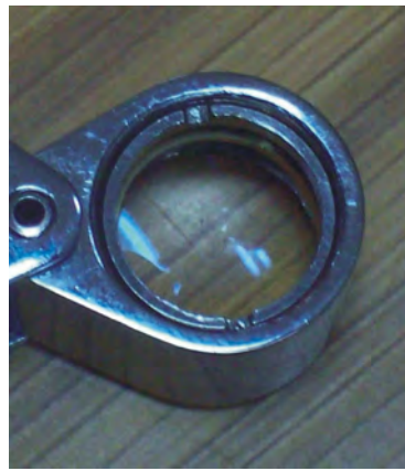
Figura 4.15: Lente propagadora del haz de luz en el rangefinder
