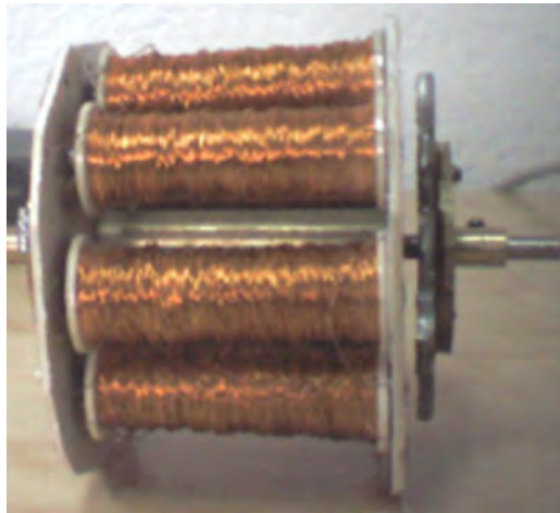
Figura 3.16: Vista del rotor inferior en uno de los motores diseñados
