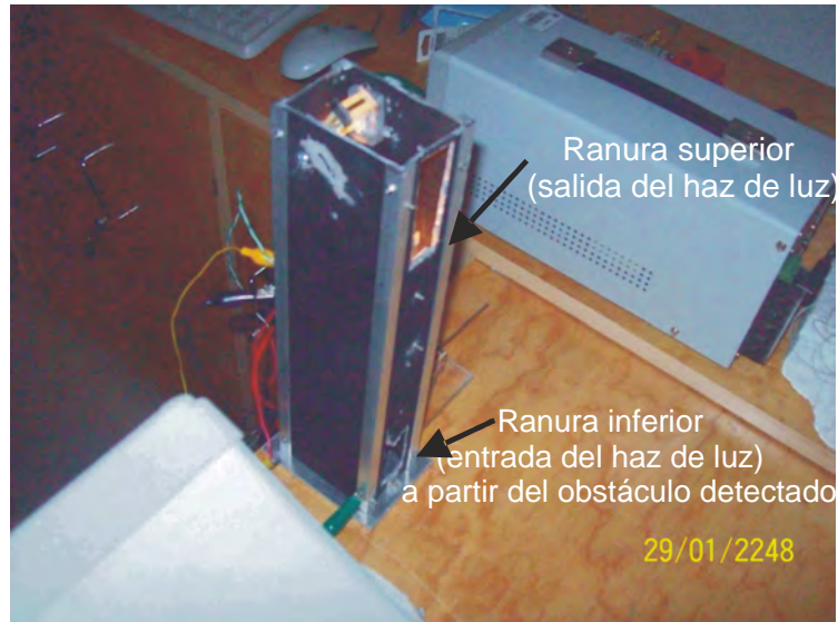
Figura 5.2: Estructura mecánica del sensor de distancias range finder con una frontal
