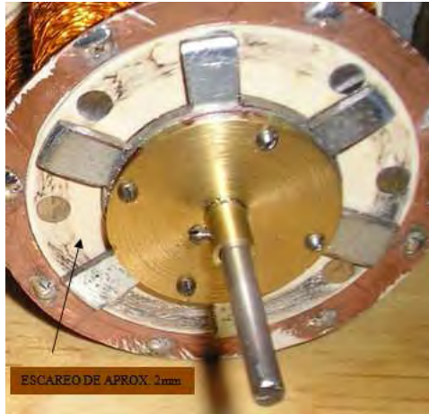
Figura 3.17: Escareo entre el estator y el rotor del motor diseñado para su libre desplazamiento
