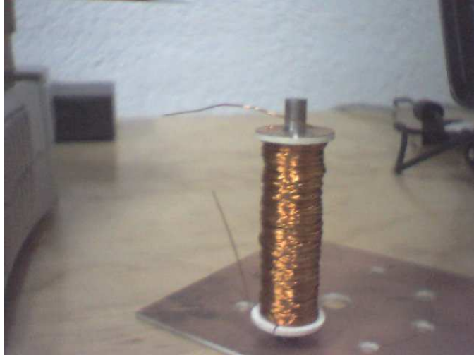
Figura 3.8: Bobina cubierta de alambre de cobre electromagnético
