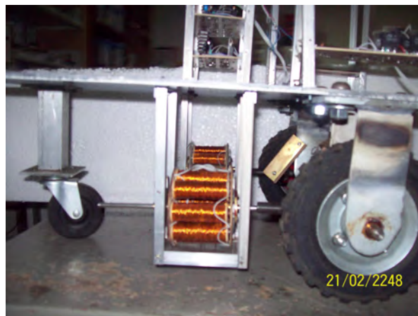
Figura 6.16: Acoplamiento de los motores a pasos de reluctancia variable en la plataforma móvil
