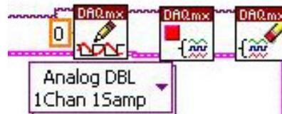
Figura 39. Detención del canal analógico limpiado del mismo.
