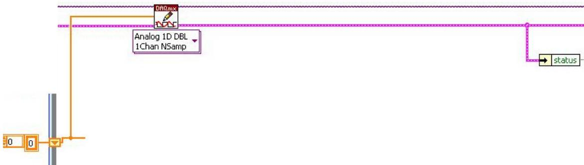
Figura 38. Envío de datos analógicos en múltiples muestras al motor.
