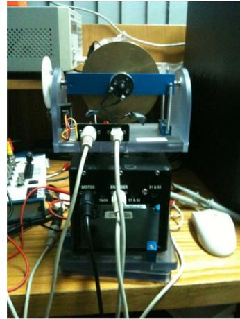
Figura 8 Módulo del giróscopo colocado sobre el servo SRV02
