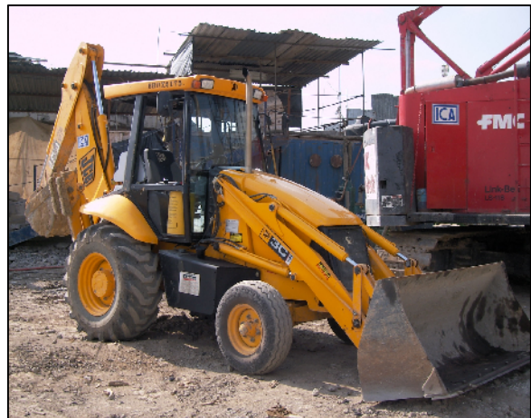
Figura 3.10.- Retroexcavadora con cargador frontal
