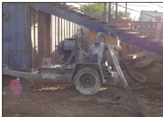
Figura 3.6.- Bombas para lodos, Gurman Rupp, estas deben tener la capacidad para bombear el lodo fraguante
