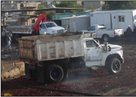
Figura 3.7.- Camiones de volteo de 6 u 8 m 3 para llevar el material excavado al sitio de tiro
