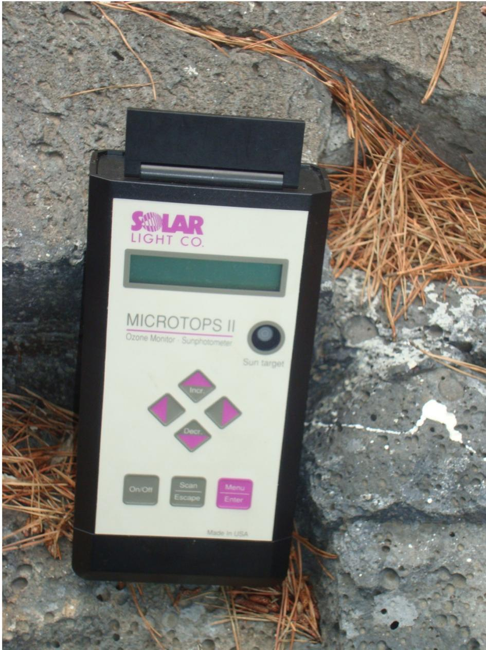
Figura 7. Fotómetro portátil MICROTOPS II utilizado en la campaña de medición del Espesor Óptico en el Noroeste de México por el Instituto de Geofísica, UNAM, durante diciembre de 2009.
