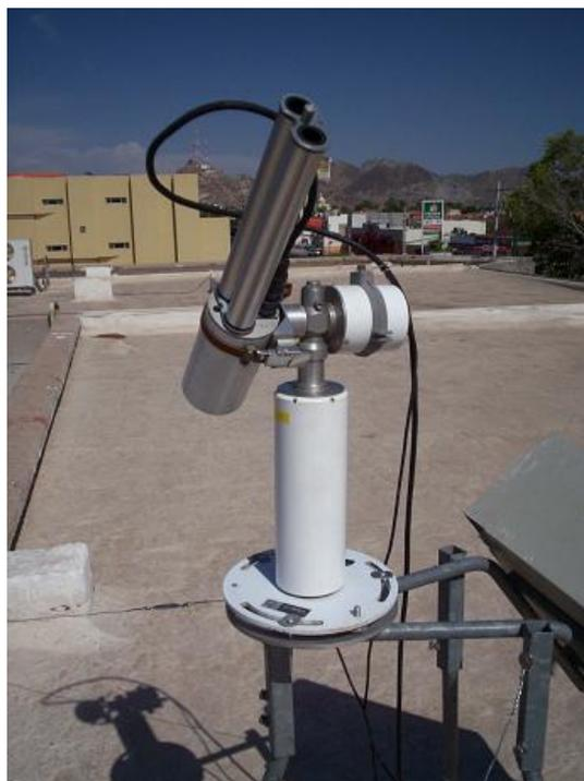
**Figura 8. Fotómetro CIMEL de la red AERONET en la ciudad de Hermosillo, Sonora. Fuente: Observatorio de Radiación Solar, Instituto de Geofísica, UNAM. [http://rayenari.geofisica.unam.mx/~hector/cimel\\_hillo.ht](http://rayenari.geofisica.unam.mx/~hector/cimel_hillo.ht)**
