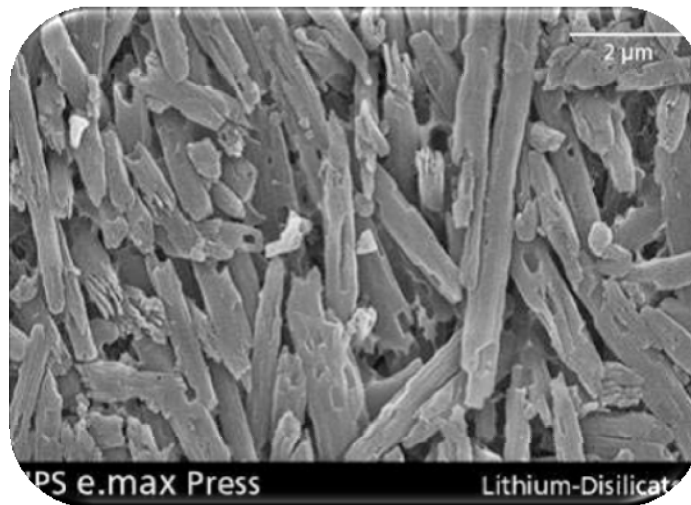
Fig. 15 Cristales de disilicato de litio.
