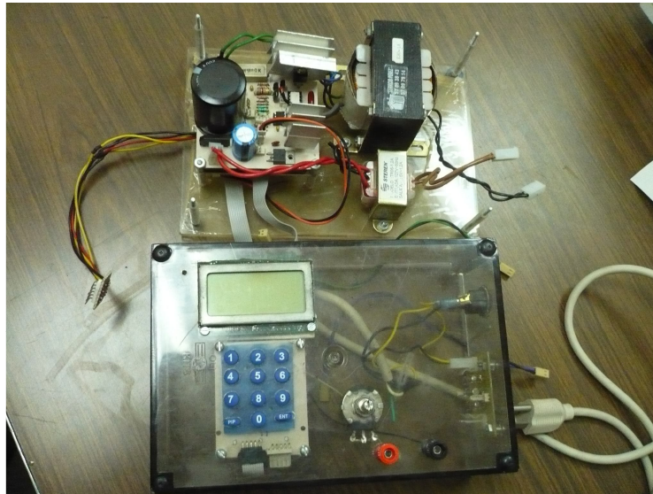
Figura 5.12.a “Sistema de electroporación ensamblado en una caja de proyectos PROKIT”
