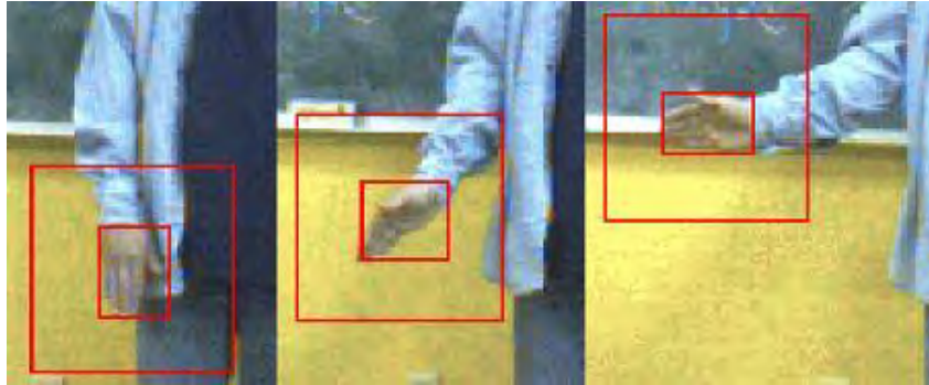
Fig. 2.11 Seguimiento. Se ilustra el proceso de seguimiento de una región, el cuadro exterior define la región de búsqueda.
