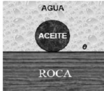
Figura 3.2 Sistema completamente mojado por agua. La gota de aceite es tangente a la superficie de la roca. Angulo de contacto igual a cero.
