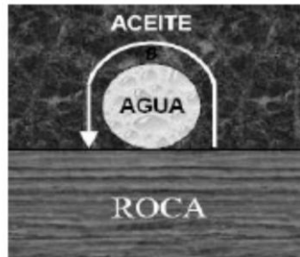
Figura 3.4 Sistema completamente mojado por aceite. La gota de agua es tangente a la superficie de la roca. Angulo de contacto igual a 180 grados.
