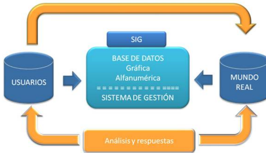
Fig. 3.1 Esquema Conceptual de un SIG.
