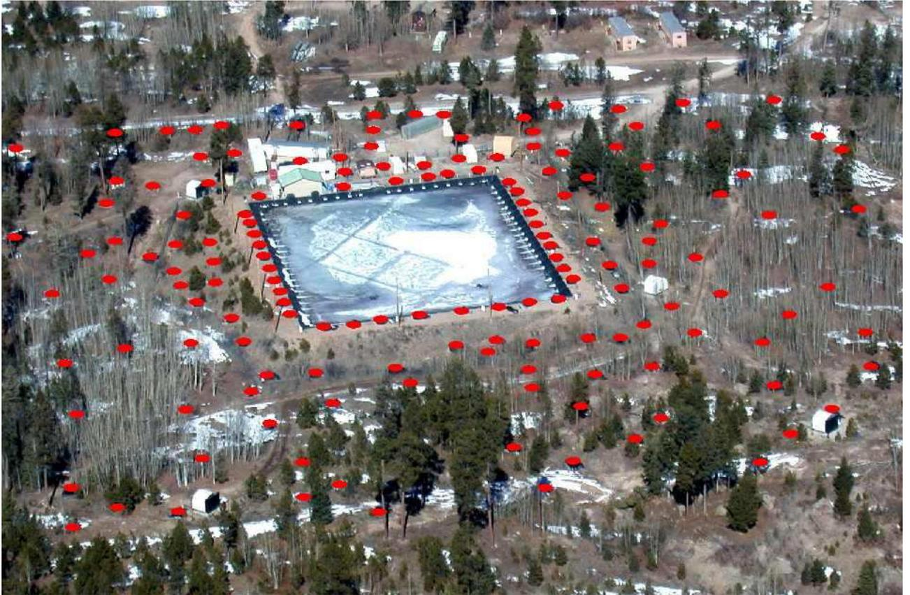
**Figura 3.1:** Vista aérea del Observatorio Milagro. El reservorio central estaba cubierto por una capa hermética, mientras los puntos rojos representan el arreglo exterior llamado “outrigger”.
