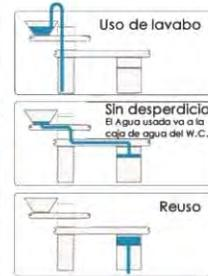
Sistema en el cual el agua que se utiliza para el lavabo va directamente al depósito de la taza, permitiendo su reuso.
