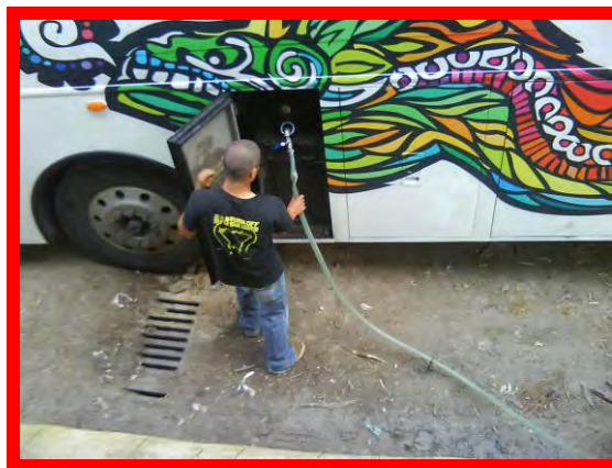
Fig. 5.13 Llenado del tanque de almacenamiento del biodiésel en el autobús
