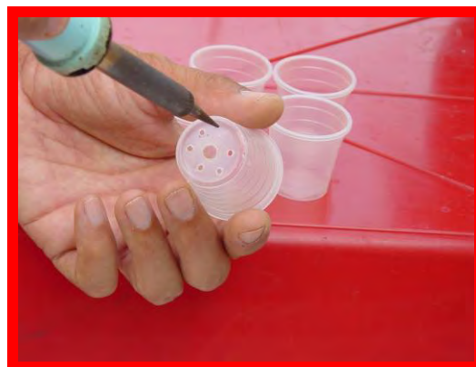
Fig. 4.2 Perforación de la base de los contenedores
