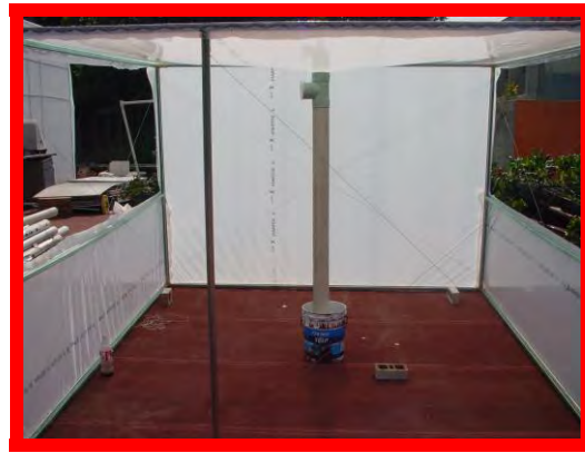
Fig. 4.13 Sistema de aireación
