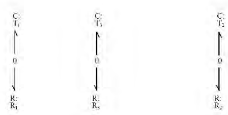
Figura 5.2: Puntos de esfuerzo común en el BG del sistema de tres tanques
