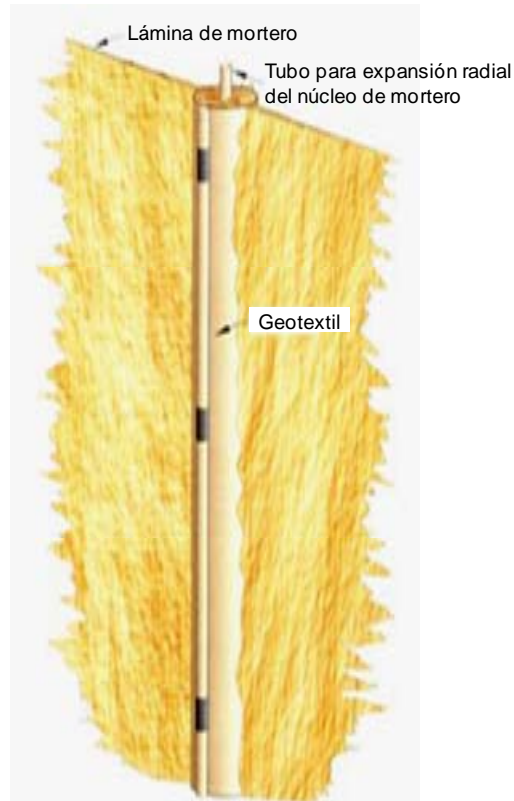
Figura 1.2.12 Inclusiones inyectadas envueltas en geotextil (Santoyo et al., 2005)
