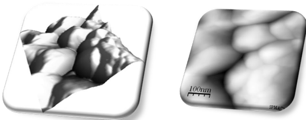
Fig. 4.30 Imagen de AFM en donde se observa la topología de la película 120W.
