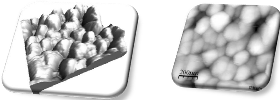
Fig. 4.27 Imagen de AFM en donde se observa la topología de la película 60W.
