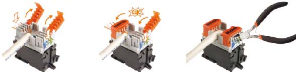
Figura 3.14 diagrama de armado Conector RJ45.
