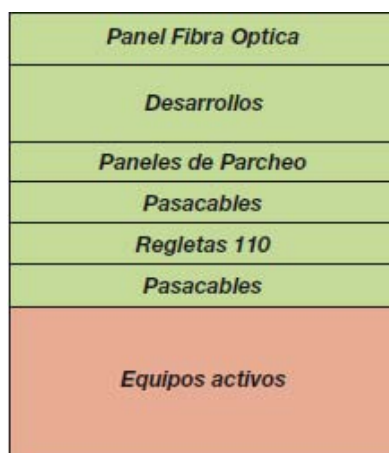
Figura 3.16 Armario de Telecomunicaciones.
