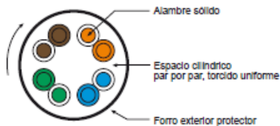
Figura 1.7 Arquitectura del cable STP.
