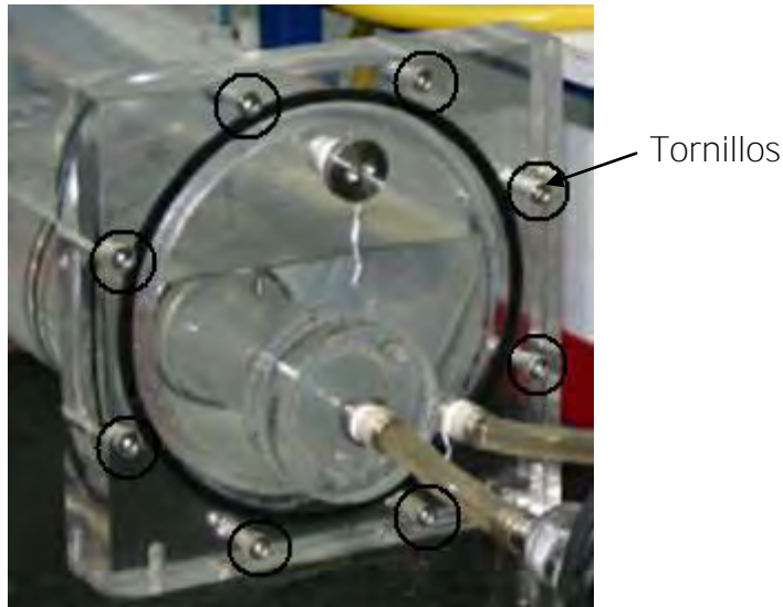
Figura 3.5. Configuración de cierre del tanque mediante tornillos.
