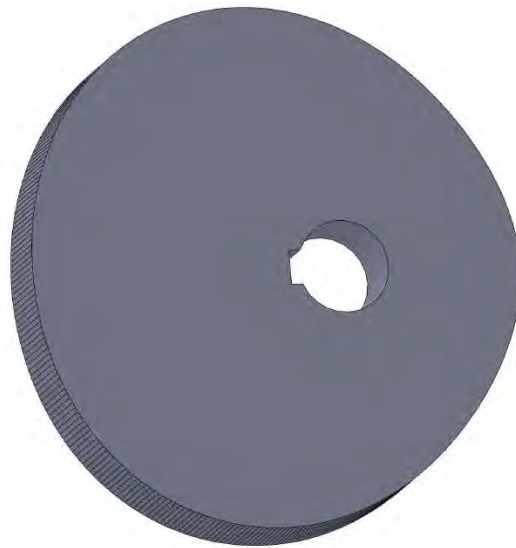
Figura 5.13. Diseño en CAD de la leva
