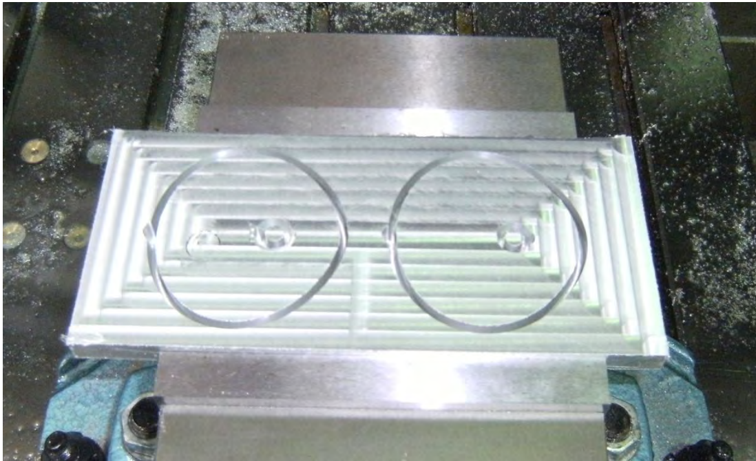
Figura 5.17 Manufactura de la leva.
