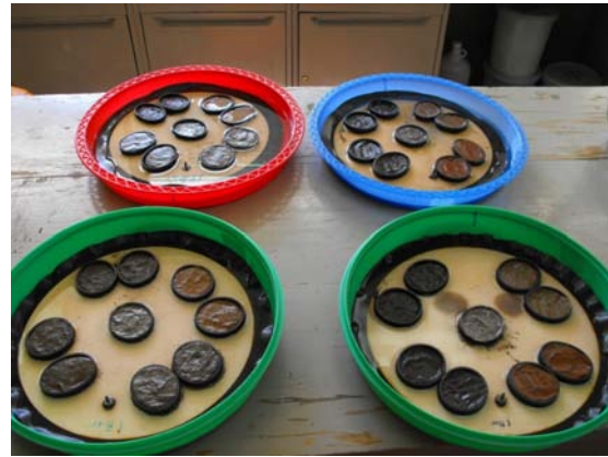
Figura 4.6. Muestras saturadas mediante capilaridad.
