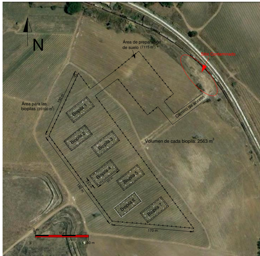
Figura 5.35. Diagrama de la ubicación de las 7 biopilas propuestas y del área de preparación del suelo.
