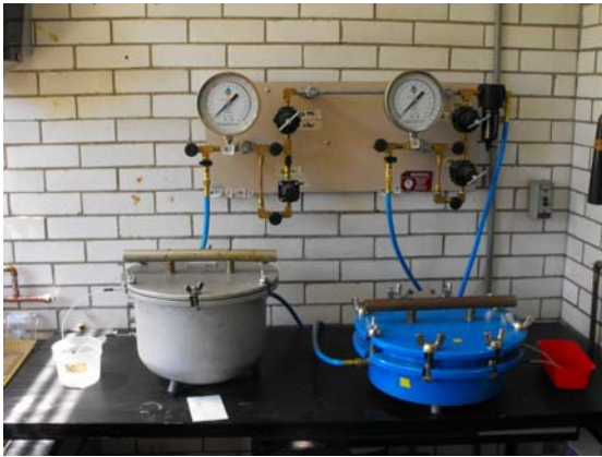
Figura 4.5. Autoclave para el drenado de suelos
