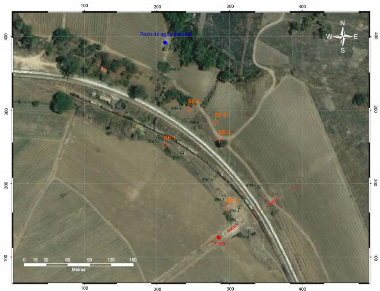
Figura 4.1. Ubicación de los pozos instalados en el sitio contaminado, PM: pozos de monitoreo; SE: sondeos exploratorios.
