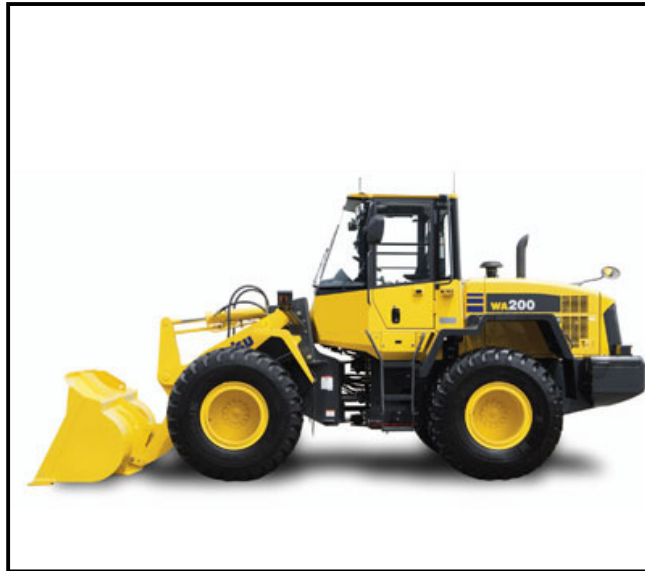
Fig. 29. Cargador frontal con una capacidad de 3.1 yd 3 .
