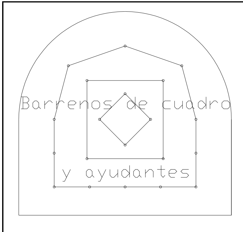
Fig. 15. Barrenos de cuadro y ayudantes para una sección de 4.5 m X 4 m.
