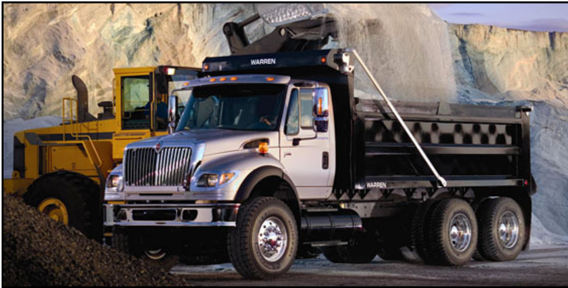
Fig. 33. Camión convencional de 25 toneladas de capacidad.
