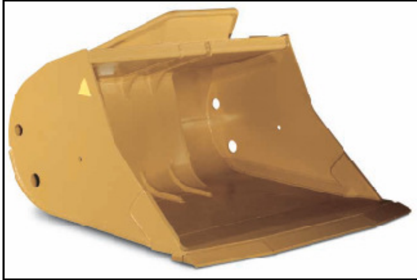
Fig. 31. Cucharón y cuchillas de un cargador frontal de bajo perfil de 6 yd 3 .
