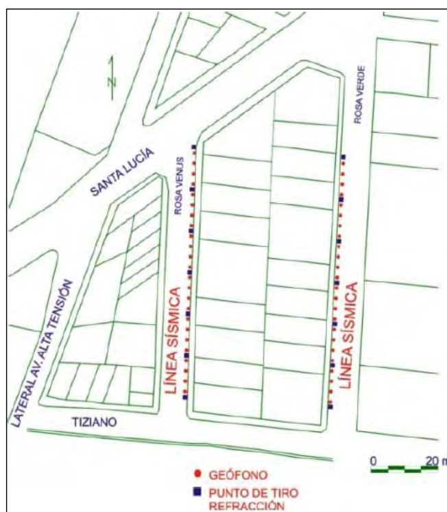
Figura 2.5. Geometría de adquisición de refracción sísmica vista en planta en la Col. El Alfalfar.
