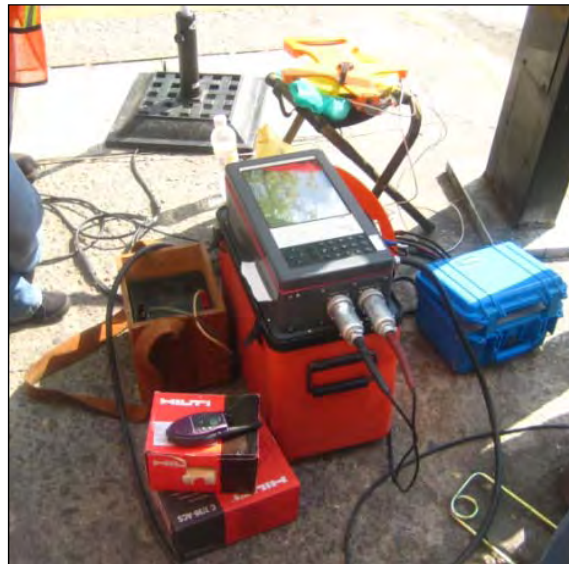
Figura 2.3. Equipo de adquisición sísmica. Sismógrafo, batería de alimentación, cables y fuente de energía.
