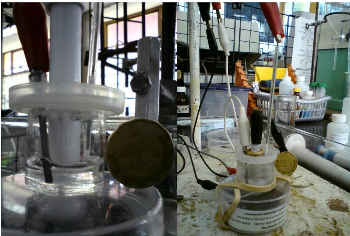
Celdas usadas para la determinación y recuperación de mercurio(II). Izquierda, ET disco de oro, EA barra de grafito y ER  $Ag^0|AgCl(s)|KCl_{sat.}|$ ; derecha, ET disco de grafito, mismos EA y ER.
