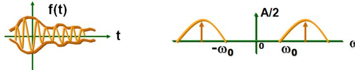
Obsérvese que la señal  $f(t)$  es desplazada a  $\omega_0$  y  $-\omega_0$  por efecto de multiplicarse por  $\cos \omega_0 t$
