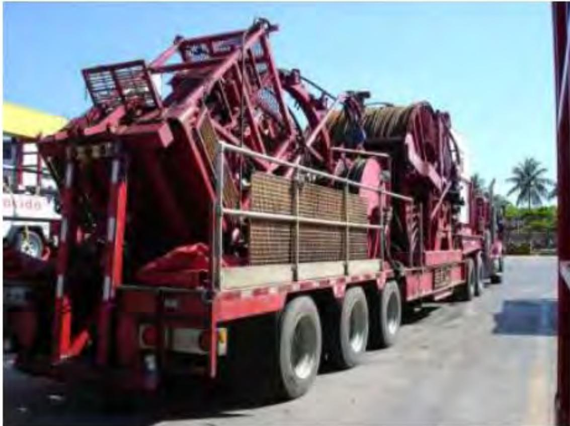
**Fig. 1.7** Equipo de tubería flexible.
