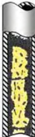
**Fig. 1.3 Flujo transición para tuberías verticales.**
