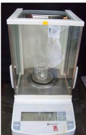
**Figura 12. Pesando el catalizador en la balanza Ohaus.**
