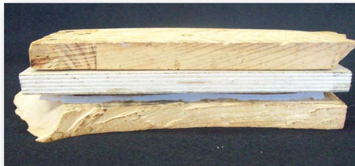
**Figura 21. Colocación de tablas por arriba y abajo del suaje.**
