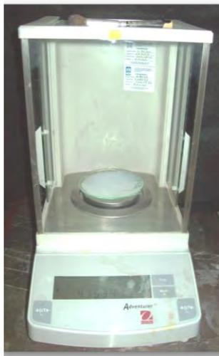
**Figura 11. Pensando la base del silicón con la Balanza Ohaus .**
