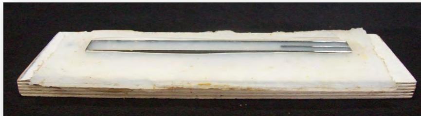
**Figura 24.** Corte del silicón con el suaje para la prueba de desgarre.
