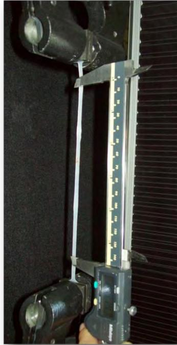
**Figura 32. Medición de muestra terminando la prueba de elongación.**
