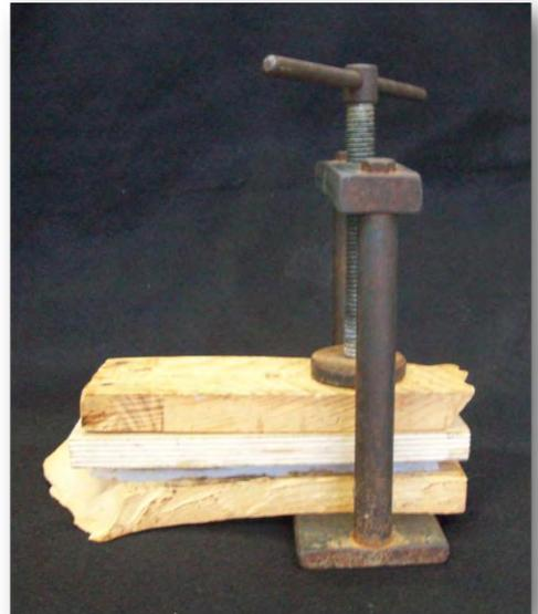
**Figura 22 y 23.** Prensado de los extremos para el corte de la placa de silicón con los suajes.
