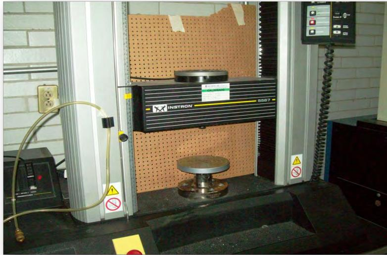
**Figura 29. Maquina universal de pruebas mecánicas INSTRON.**
