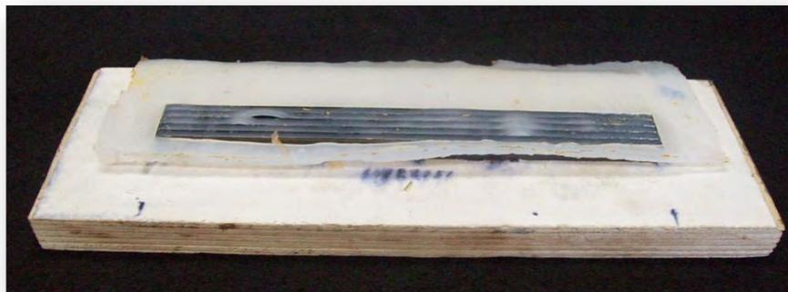
**Figura 25.** Corte del silicón con el suaje para la prueba de elongación.
