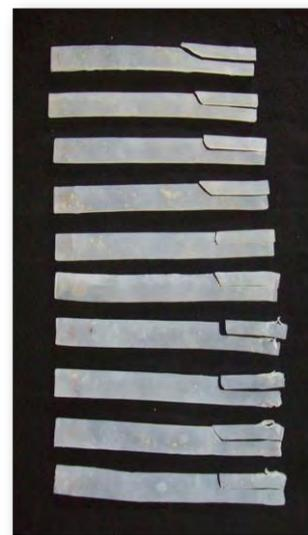
**Figura 34. Muestras después de la prueba de desgarre la prueba de desgarre.**
