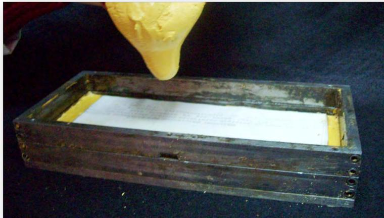
**Figura 7. Vaciado de yeso en la mufla.**
