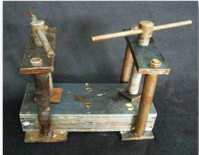
Figura 19. Prensado en los lados de la mufla utilizando dos prensas.
