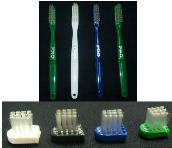
Figura 21. Muestras fijadas a la base con silicón de barra comercial.
