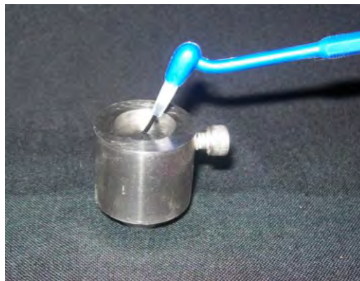
Figura 8. Colocación de la primera capa de resina y fotopolimerización.
