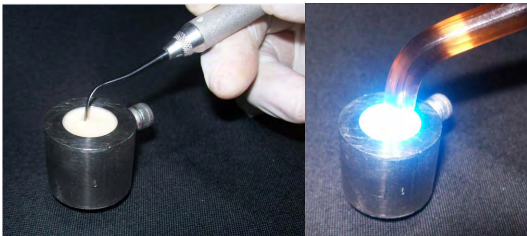
Figura 8. Colocación de la primera capa de resina y fotopolimerización.
