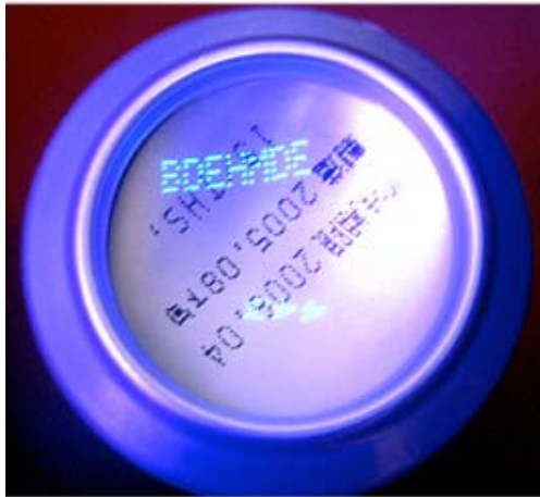
Tinta invisible aplicada a envase de lata
