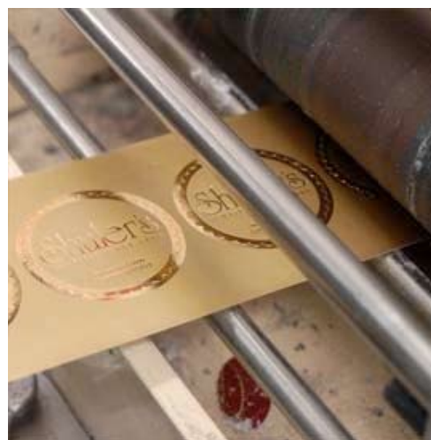
Etiquetas elaboradas por medio de hot stamping.
