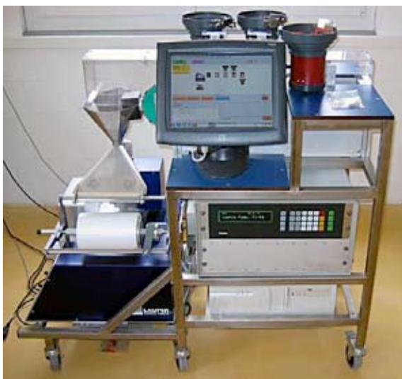
Máquina para llevar a cabo la transferencia térmica de una película al envase.
