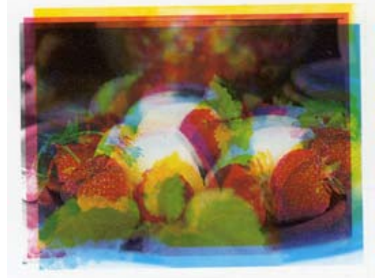
Falla de Registro
