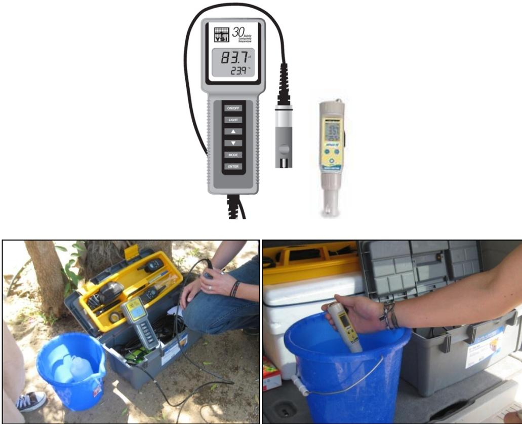
Para la obtención de la lectura de pH se utilizó un pHímetro marca Oakton modelo pHTestr20 con una resolución 0.01pH, calibrado de fábrica (FIGURA A1.2).
