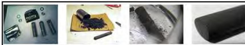
Figura 4.6 Electrodo a emplear en una CCM
