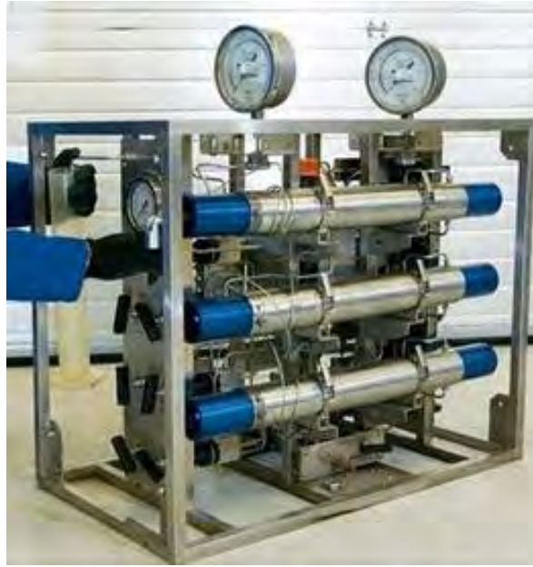
Figura 2.14. Recolector Múltiple para toma de muestra en el cabezal. 18
