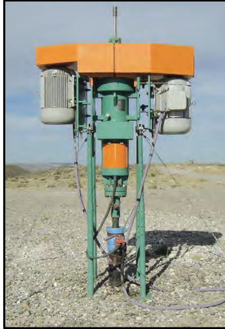
Figura 6.13 Cabezal para Bombeo de Cavidades Progresivas. 44
