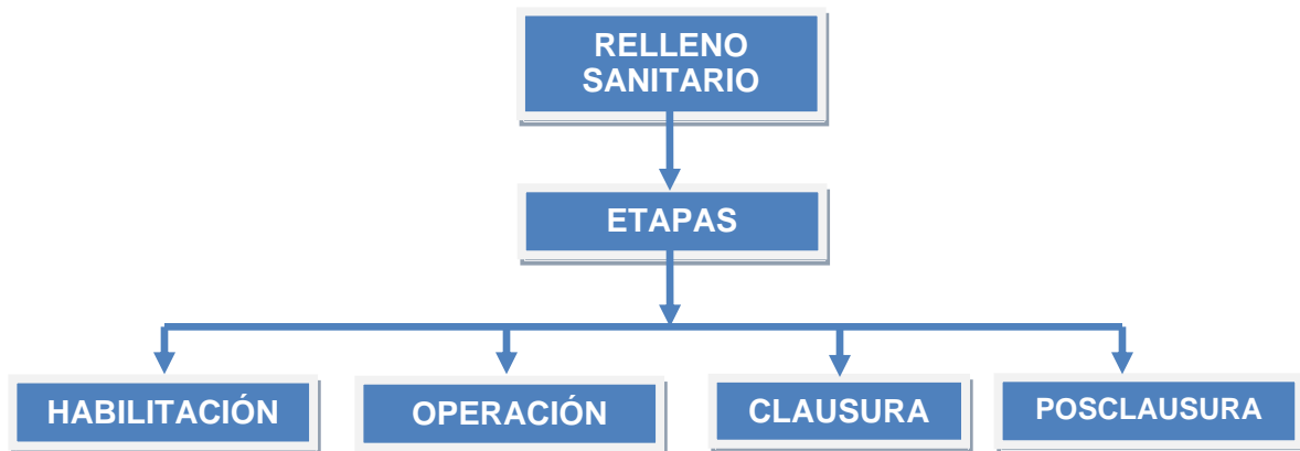
Figura 1. Etapas para la implementación del relleno sanitario
